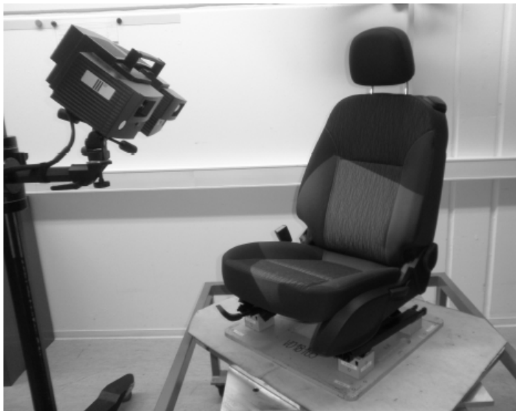
Bild 3: Messobjekt (Autositz) mit Koordinatenmesssystem und Beleuchtung
